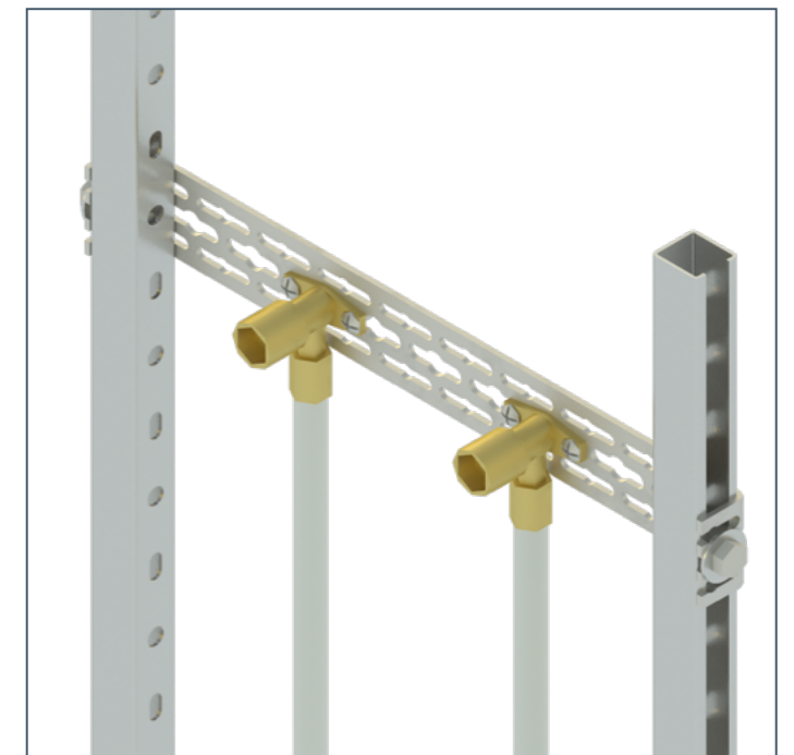
Крепление водорозеток к элементам несущего каркаса Termoclip
